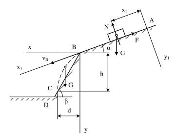
Рассмотрим движение тела на участке AB. Принимая тело за материальную точку, покажем действующие на него силы: вес  $\overline{G}$  , нормальную реакцию  $\overline{N}$  и силу трения скольжения  $\overline{F}$  .
